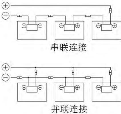
如果可能有超过组件最大保险丝电流的反向电流通过组件，必须使用相等规格的过电流保护装置来保护组件。如果并联数量大于等于 2 串，在每串组件上必须有一个过电流保护装置。
