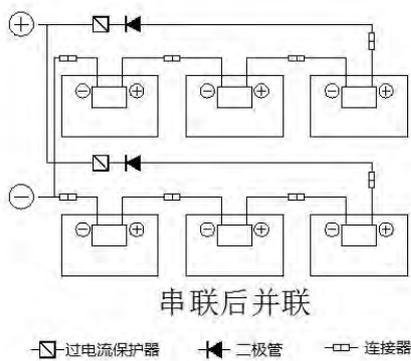
组件的设计中，现场的连接使用密封的防护等级为 IP67 的接线盒，为导线及其相应的连接提供环境影响的防护，为未绝缘带电部件提供可接触的防护；接线盒有连接好的电缆线和防护等级为 IP67 连接器，这些设计便于组件间的串联；每一块组件有两根单独连接到接线盒内的导线（一个正极、一个负极），通过把一个组件导线另一端的正极接口插入相邻组件的负极导线的插口，就可以把两个组件串联。
