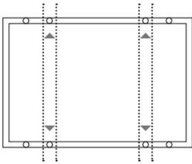
使用外侧或内侧 4 个螺栓安装孔安装，导轨与长边框垂直
